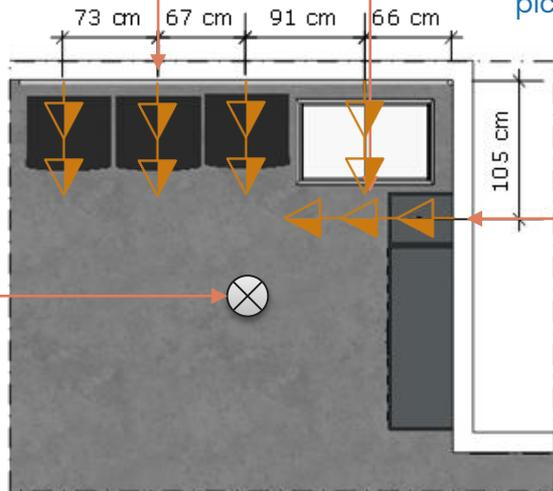
Câmera instalada na laje. Verificar boa visibilidade da câmera para todos os equipamentos e mobiliário.
